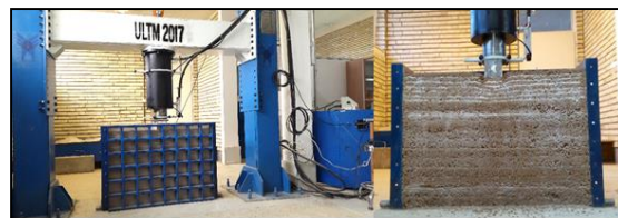
شکل ۳- مدل واقعی سیستم بارگذاری و نمونه‌های آزمایشگاهی
