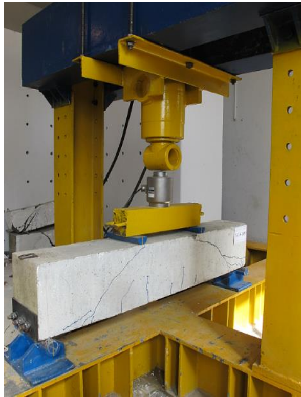
شکل ۵- آزمایش خمش چهار نقطه‌ای نمونه NC-S-1.05
