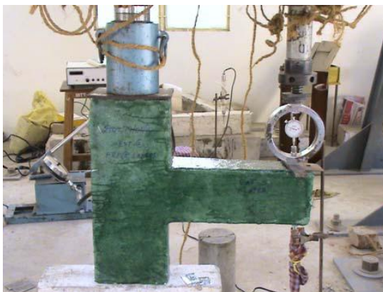
شکل ۴- اعمال بار متناوب لرزه‌ای بر اتصال تیر- ستون تقویت شده با GFRP توسط جک هیدرولیکی در آزمایشگاه
