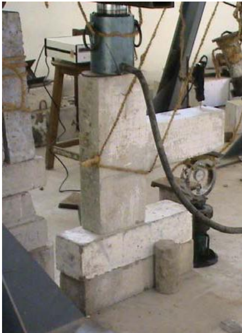
شکل ۳- اعمال بار متناوب لرزه‌ای بر اتصال تیر- ستون توسط جک هیدرولیکی در آزمایشگاه
