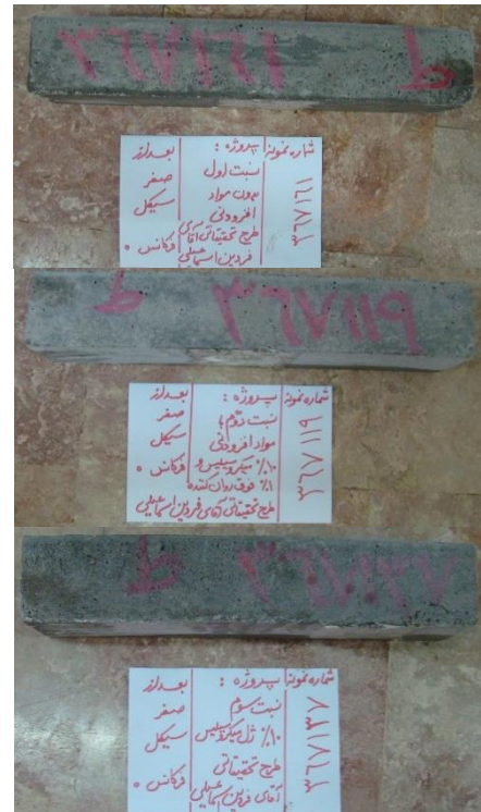
شکل ۳- نمونه بعد از صفر سیکل در نسبت‌های اول، دوم و سوم
