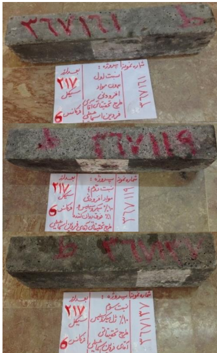
شکل ۵- نمونه بعد از ۲۱۷ سیکل در نسبت‌های اول، دوم و سوم
