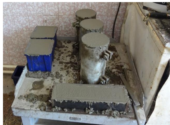
شکل ۲- نمونه برداری از بتن برای آزمایش بتن سخت شده
