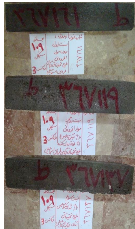
شکل ۴- نمونه بعد از ۱۰۹ سیکل در نسبت‌های اول، دوم و سوم
