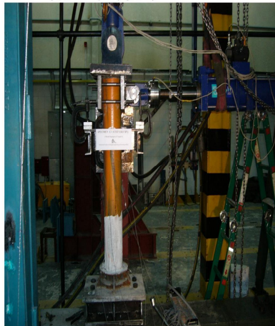
شکل ۷ - نمونه ستون CFST تحت آزمایش
