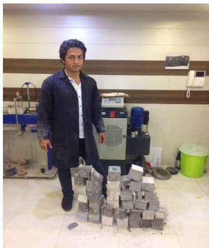
شکل ۳- نمونه آزمایش شده در جک بتن شکن
