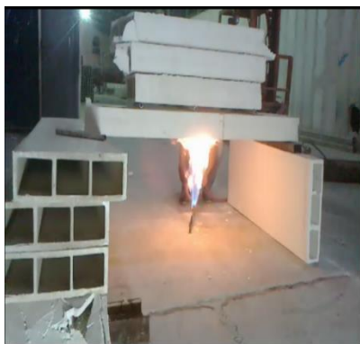
شکل ۱۴- آزمایش مقاومت در برابر حریق [۱۲]
