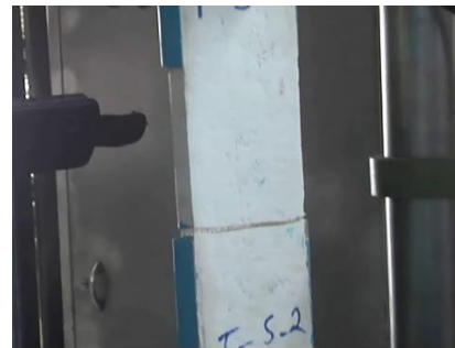
شکل ۷- گسیختگی قطعه در آزمایش مقاومت کششی [۱۲]
