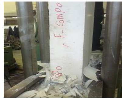
شکل ۶- گسیختگی پانل در آزمایش مقاومت فشاری [۱۲]
