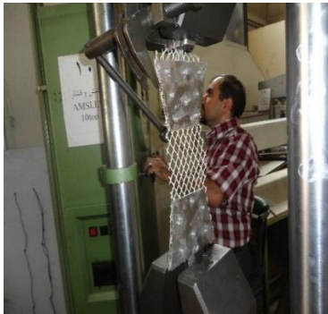
شکل ۴- شکل پذیری مش توری تحت آزمایش کشش
