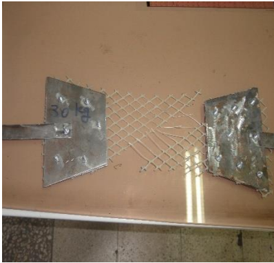
شکل ۳- آزمایش کششی مش توری پلاستیکی [۱۲]
