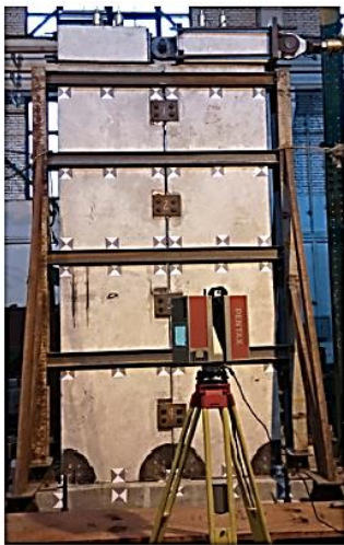
شکل ۵- الگوی بارگذاری چرخه‌ای تست ۵ و جزئیات نمونه آزمایشگاهی ساخته شده در مطالعه Guo و همکاران [۱۱]
