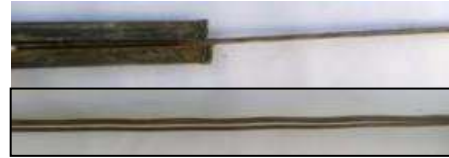
شکل ۱۱- کمانش هسته مهاربند سه هسته‌ای بعد از بارگذاری
