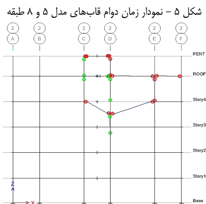
الف) مود خرابی سازه ۵ طبقه با شکل‌پذیری متوسط در زمان ۱۱/۶۴ ثانیه
