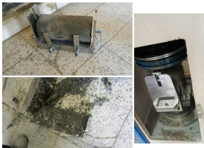
شکل ۴-۱۳ نحوه آماده سازی و آزمایش نمونه ها در حالت فاصله ۲ سانتی متری از تار خنثی
