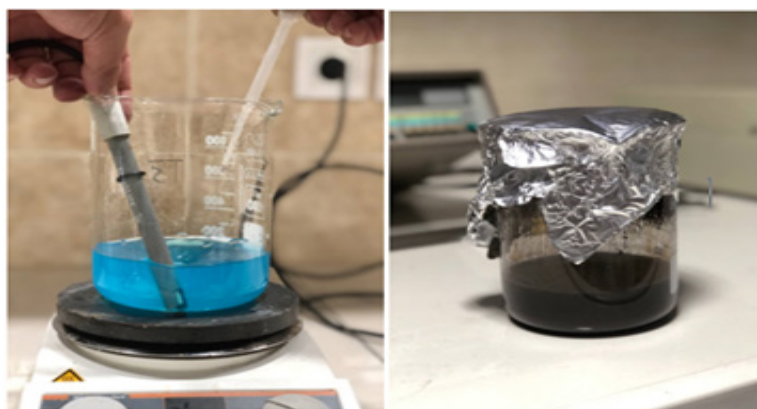
شکل ۱: تغییر رنگ نانوذرات اکسید مس در طی فرایند تولید از آبی شفاف به کدر و سپس سیاه
