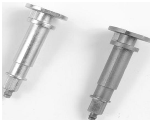
شکل (۱۱): فولاد زنگ‌نزن سمت راست قبل و سمت چپ بعد از الکتروپولیش (۱۸)
