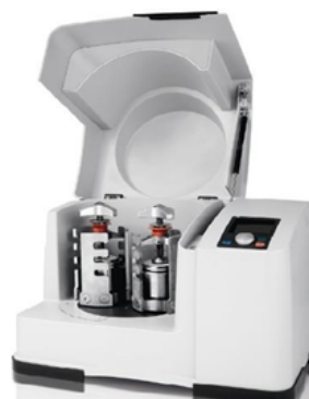
شکل ۱ تصویر دستگاه آسیاب گلوله‌ای سیاره‌ای
