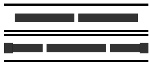
شکل (۱۰): شمای مدار چاپی در دو وجه لایه میانی فیلتر با چهار تزویج کننده
