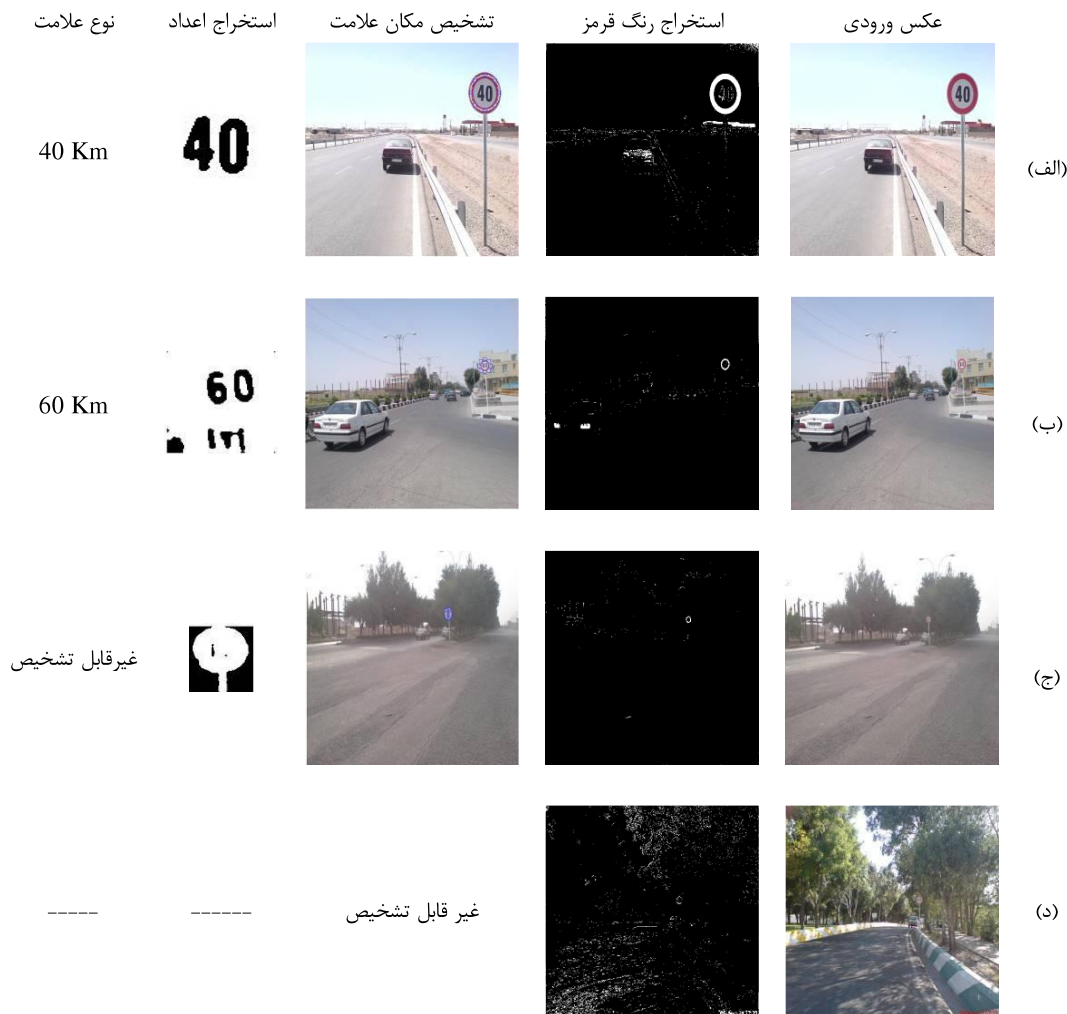
شکل (۱۳): (الف) فاصله ۵ متر (ب) فاصله ۳۰ متر (ج) فاصله بسیار دور (د) فاصله ۳۰ متر و نویز ۳۰ درصد Fig. (13): (a) The 5 meters (b) 30 meters (c) Long distance (d) 30 meters and 30 percent noise
