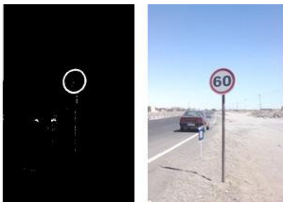
شکل (۲): نتیجه اعمال فیلتر HSI و استخراج رنگ قرمز Fig. (2): The result of applying HSI filter and extracting red colour
