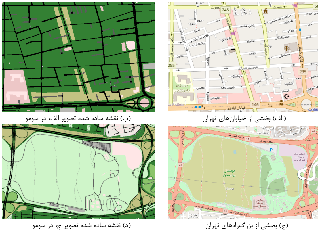
شکل (۴): تصاویر سناریوی شبیه‌سازی شده شهری و بزرگراهی (الف) بخشی از خیابان‌های تهران (ب) نقشه ساده شده تصویر الف، در سومو (ج) بخشی از بزرگراه‌های تهران (د) نقشه ساده شده تصویر ج، در سومو
