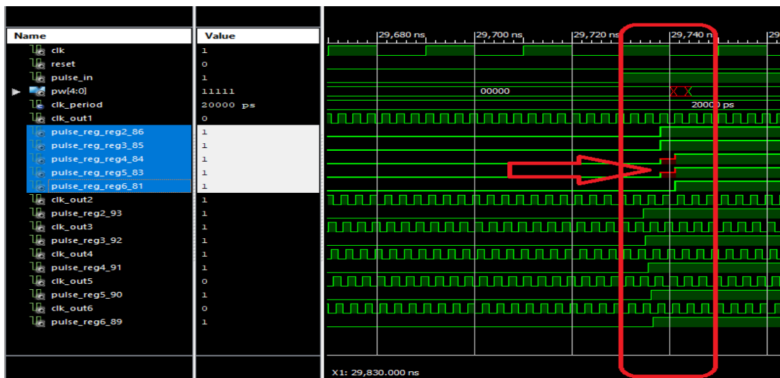
شکل (۶): تأخیر اجتناب‌ناپذیر در معماری کلی-دقیق برای انتقال داده Figure (6): Inevitable delays in coarse-fine architecture for data transfer
