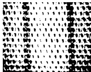
شکل (۳): تصویر دودویی شده پارچه معیوب Figure (3): The binary image of defective fabric
