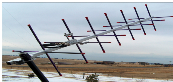
شکل (۲): آنتن گیرنده دو قطبی دارای شاخک‌های عمود بر هم Fig. (2): Dual polar antenna receiver with perpendicular antennas
