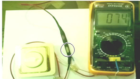
شکل (۷): اتصال مورد آزمایش در دمای ۷۴ درجه سانتی‌گراد Fig. (7): The tested connection at 74 ° C
