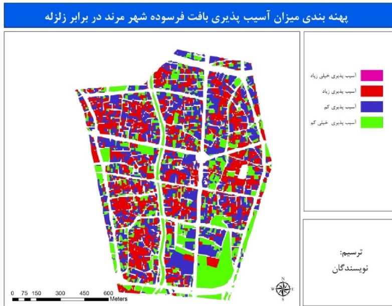
نقشه ۸: پهنه‌بندی نهایی میزان آسیب‌پذیری بافت فرسوده شهر مرنند در برابر زلزله (مأخذ: نویسندگان)
