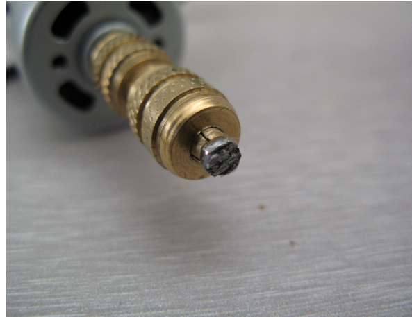
نگاره ۱- پروب ساینده که بر روی سه نظام، محکم شده و مجموعه بر روی موتور الکتریکی متصل گردیده است.
