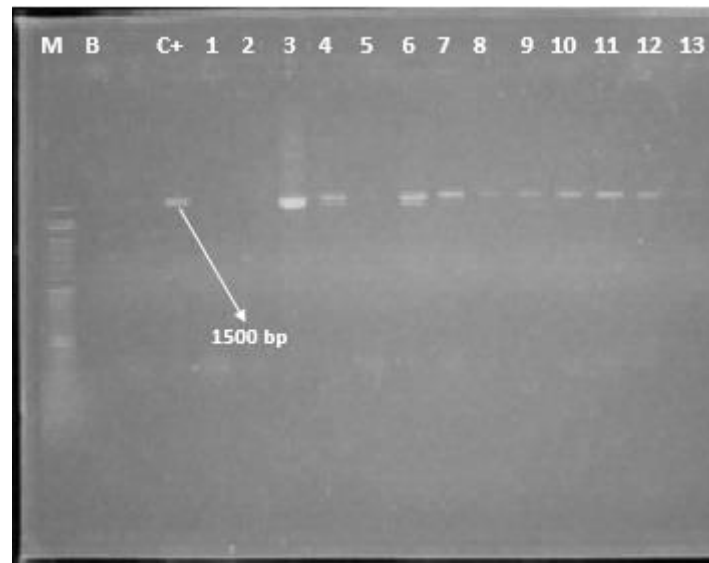
شکل (۱)- محصول PCR صورت گرفته روی ژن کامل 16s rDNA (1500 bp) از جدایه‌ها که با استفاده از پرایمرهای یونیورسال (27f و 1525r) تقویت شده است. M: مارکر 50 جفت بازی، C+: شاهد مثبت. شماره‌های ۱-۱۳ جدایه‌های باکتری‌های لاکتیک/اسید مورد مطالعه. B (بلانک): شاهد منفی (مخلوط واکنش فاقد DNA الگو).
