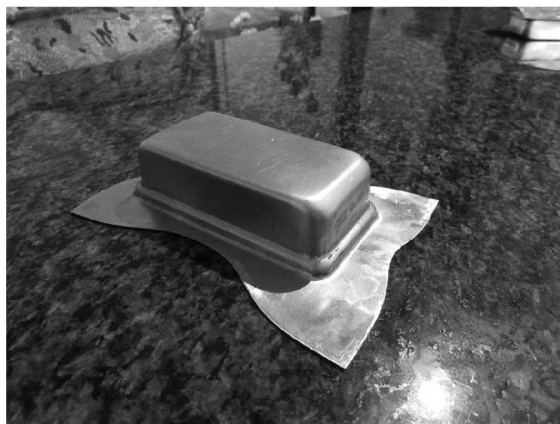
شکل ۵ نمونه تجربی قطعه کشش عمیق شده فولاد زنگ نزن St_{37} با نیروی ورقگیر ۵۰ بار
