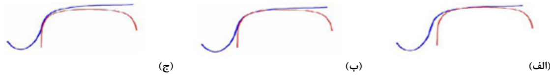
شکل ۳: تماس چرخ با ریل (الف) تماس یک نقطه‌ای مخروطی، (ب) تماس دو نقطه‌ای مخروطی و فلنج، (ج) تماس یک نقطه‌ای فلنج [۷].
