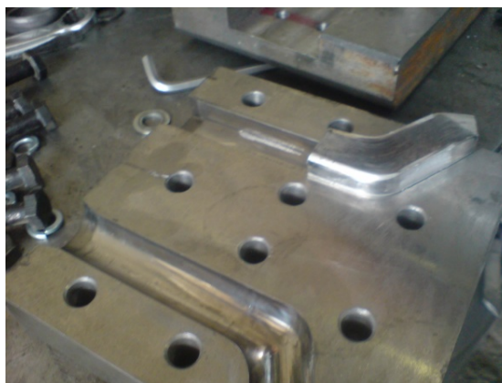
شکل ۲ قالب ساخته شده برای عملیات پرسینگ با مقاطع مربعی و دایره ای ، قالب باز
