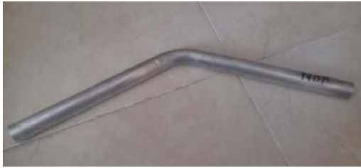
شکل ۱۱- نمونه مورد نظر برای تست تجربی فولاد ۳۰۴
