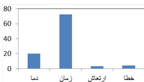
شکل ۱۷ نمودار درصد تاثیر پارامترهای آزمایش در تخلخل نمونه ها
