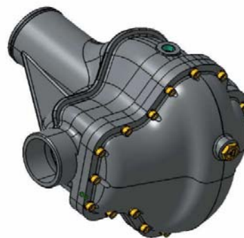
شکل ۱ مدل CAD پوسته دیفرانسیل در نرم افزار CATIA
