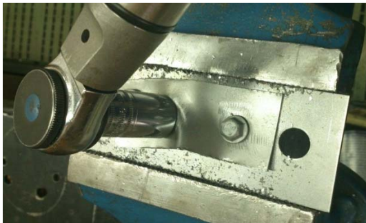
شکل ۴ تثبیت نمونه ها با ورق تقویتی بوسیله پیچ و مهره
