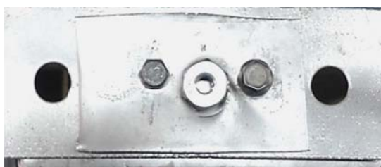
شکل ۵ آزمون پیچشی مهره جوش
