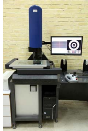
شکل ۸ دستگاه ویدیو پروفاایل جهت اندازه گیری زوایای قطعات شکل دهی داده شده
