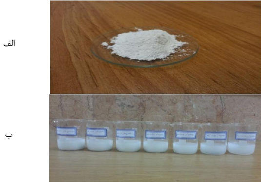
شکل ۱ الف) نانوذره هیدروکسید منیزیم، ب) نانوسیال تولید شده به روش دو مرحله ای
