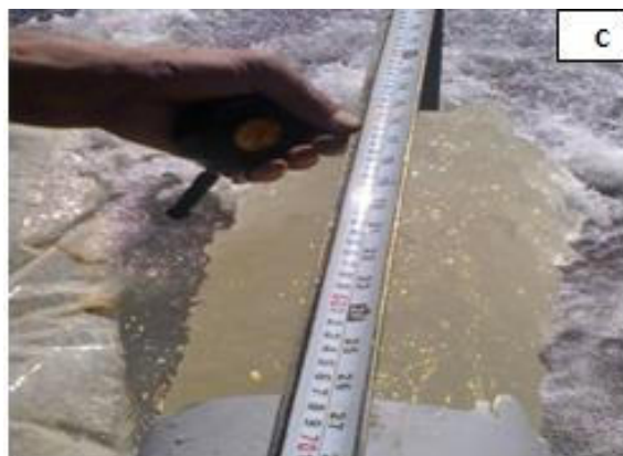
شکل ۳- A: تجهیزات سر چاهی برای اندازه گیری ماسه دهی B: مخزن ۵۰۰ لیتری برداشت آب سر چاهی C: تعیین میزان ماسه دهی در دبی خروجی چاهها
