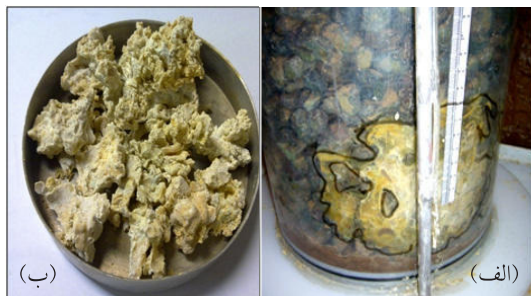
شکل ۵- الف) شورابه های تشکیل شده در سلول شن زهکش ب) نمونه شورابه های ایجاد شده در سازه فروشویی شماره ۲ معدن سرچشمه
