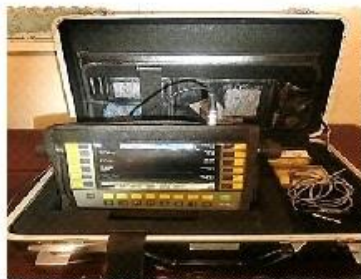
شکل ۲- مراحل انجام تست‌های غیرمخرب میدانی در ساختمان‌های در حال ساخت بتن آرمه منطقه یک تهران (پژوهش حاضر) الف- تست چکش اشमितس روی دیوار برشی ب- تست چکش اشमितس روی ستون ج- تست کشش میلگرد در آزمایشگاه د- دستگاه اولتراسونیک مورد استفاده
