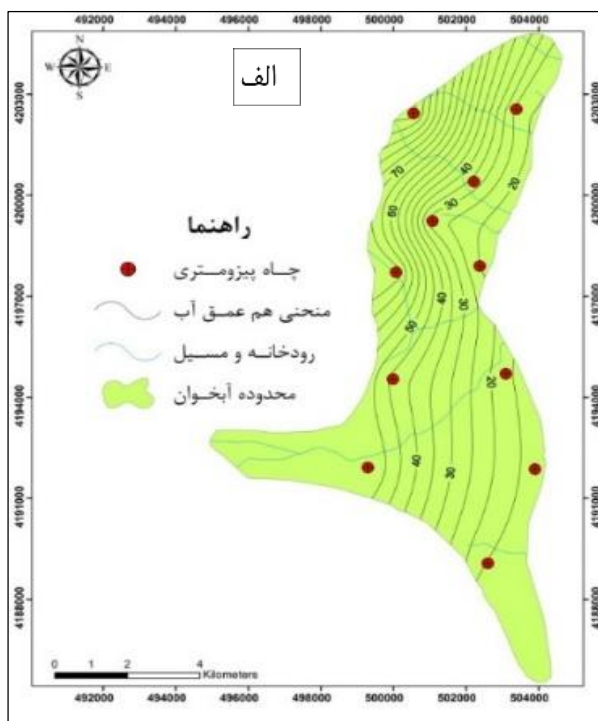
شکل ۲- الف) نقشه هم عمق و ب) نقشه هم تراز سطح آب زیرزمینی آبخوان دشت کهریز
