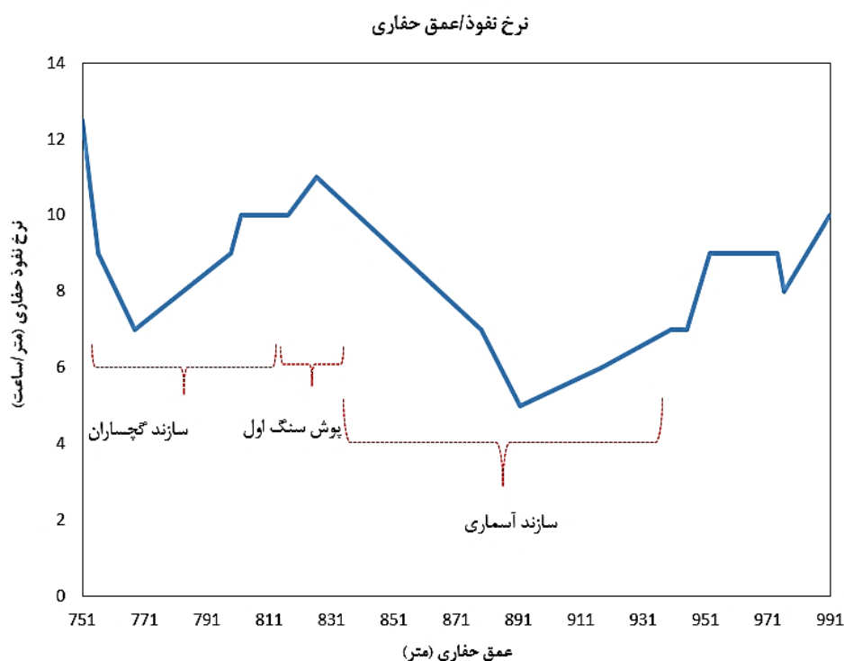
شکل ۴: نمودار نرخ نفوذ بر حسب عمق حفاری در سازندهای مختلف میدان ابوذر
