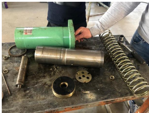
شکل ۱۲. اجزای ضربه گیر هیدرولیک مدل مخروطی
