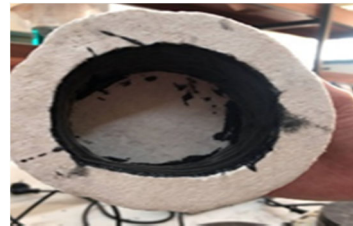
شکل ۳- اعمال مخلوطی از پودرهای گرافیت، کاربید سیلیسیوم و چسب اتصال دهنده بر دیواره داخلی کوره.
