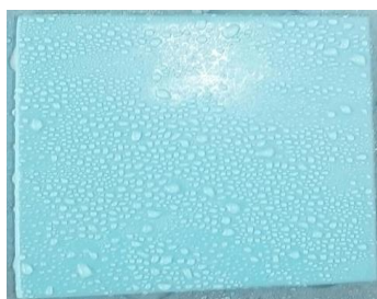
شکل ۵: نمونه کامپوزیت رنگ اپوکسی تقویت شده با دی‌اکسید تیتانیوم ضد آب
