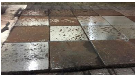
شکل ۱: نمونه‌های فولاد API 5L X52 قبل از عملیات آماده سازی
