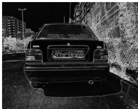
شکل ۴: به کار بردن الگوریتم تشخیص لبه
