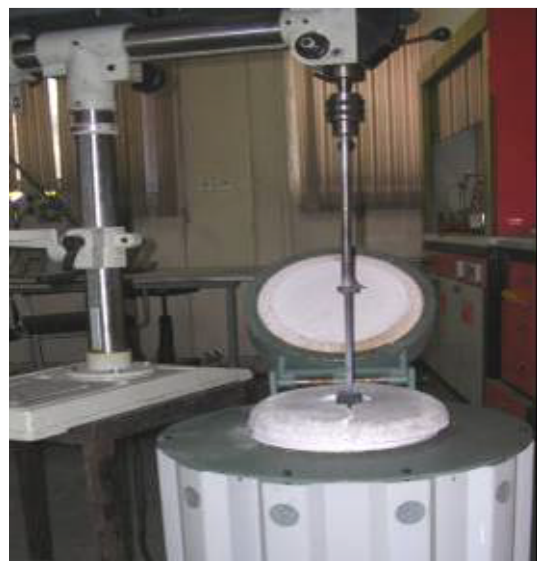
شکل ۱: سیستم ریخته‌گری ساخته شده در این پژوهش.
