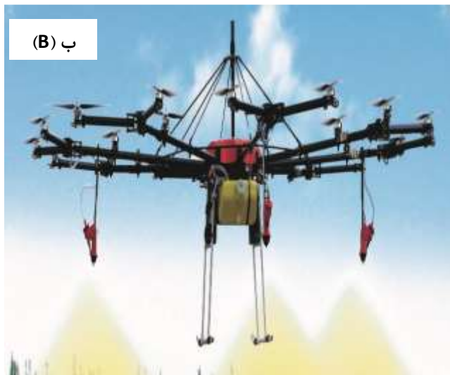
شکل ۹. تصویر برداری هوایی پهبادها از مزرعه (الف) و تصویری از یک پهباد سمپاش (ب).
