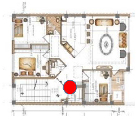
شکل شماره ۶. ایجاد هم پیوندی در محل نامناسب
