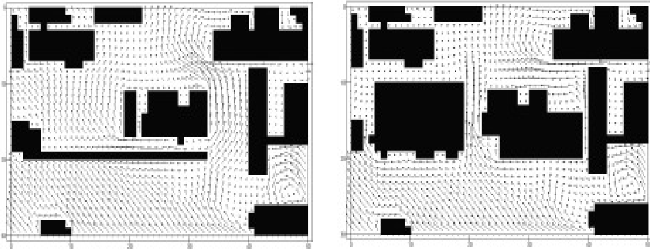
تصویر شماره ۳. الف (چپ) و ب (راست): موقعیت و چگونگی وزش باد: در شرایط موجود (الف) و بعد از توسعه (*) [ب] [۷] * جهت وزش باد ۱۳۵ درجه. برای وضوح بصری در تصویر، پوشش گیاهی موجود نشان داده نشده است.
