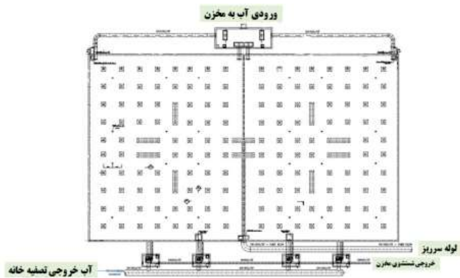
شکل ۱۰- ورودی و خروجی آب در مخزن
