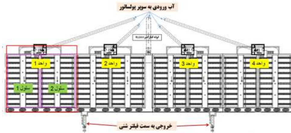
شکل ۷- ورود و خروج آب در سازه سوپرپولساتور
