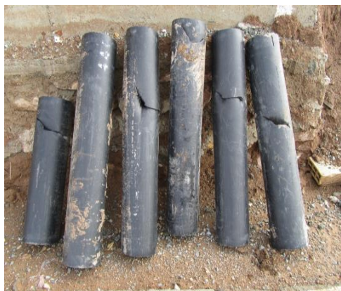
شکل ۲- مشکلات و خسارات طرح مدیریت منابع آب گاوشان (سرقت شیرآلات و شکستگی رایزر و شر خودکار) Figure 2- Problems and losses of the Gawooshan water resource management plan (theft of faucets and breakage of automatic risers and washers)
