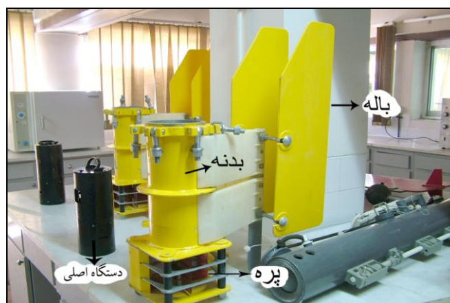
شکل ۲- جریان سنج مکانیکی مورد استفاده در اندازه گیری های جریان در تنگه هرمز
