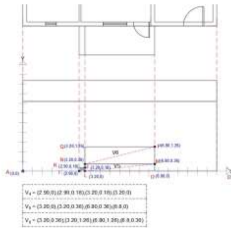
شکل ۴- نمایش نقاط و مختصات عناصر پله ، تراس و نرده در نمای یک ساختمان مسکونی یک طبقه
